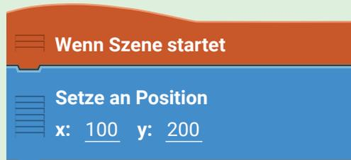
Die voreingestellten Werte 100 und 200 der beiden Parameter des zweiten Bausteins sind dabei schon an die Position der Figur angepasst.
