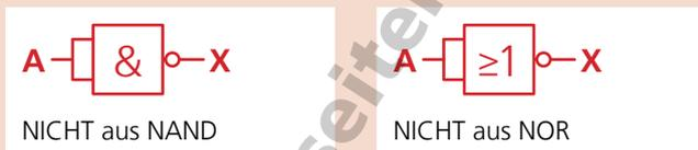
Diese einfache Möglichkeit, das Eingangssignal umzukehren wird auch bei allen weiteren Schaltfunktionen genutzt, die sich aus NAND und NOR erzeugen lassen.
