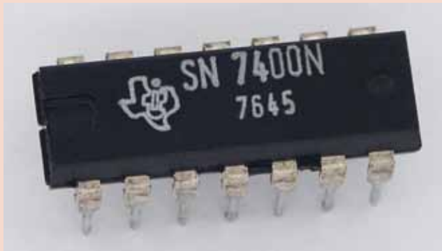
Vier NAND-Gatter mit jeweils zwei Eingängen in einem Gehäuse (Foto: Stefan506, Lizenz: CC BY-SA 3.0)
